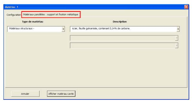
Cet onglet sert uniquement à déterminer la nature du matériau qui compose le support ou la fixation métallique. Un matériau est présélectionné par défaut et il n'est pas possible de le changer. En ce qui concerne l'épaisseur de l'ossature, aucun intrant n'est requis puisqu'elle est automatiquement établie en fonction de l'épaisseur du ou des matériaux qui composent sa cavité. Une fois les sélections indiquées, cliquez sur le
