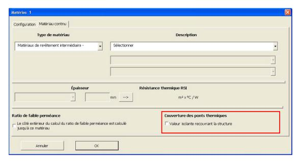
La case Valeur isolante recouvrant la structure peut être cochée lorsqu'un matériau sert de couverture aux ponts thermiques. Il est donc possible de compiler les résistances thermiques de plusieurs matériaux afin d'obtenir la valeur isolante totale recouvrant la structure (ossature).
