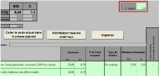
Si la composition comporte une ou plusieurs ossatures (que ce soit une ossature de bois ou d'acier), c'est l'ossature ayant la plus grande épaisseur qui va déterminer le facteur de réduction.
