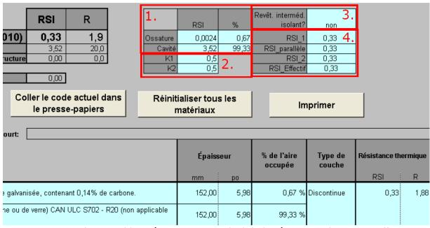
On y trouve les variables nécessaires au calcul de la résistance thermique effective d'une ossature métallique (selon le Code national du bâtiment 2010 (version révisée 2012)).
