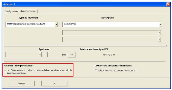
Le calcul du ratio de faible perméance nécessite la définition des parties dites « extérieure » et « intérieure » de l'assemblage.
