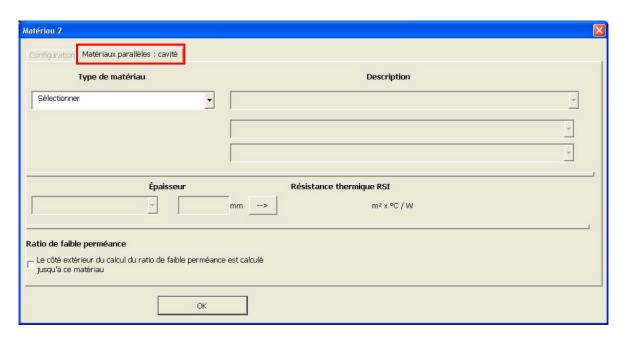
Cet onglet sert à faire la description du matériau dans la cavité de l'ossature. La méthode est semblable à celle dans l'onglet « matériau continu », mais avec des choix plus limités. L'onglet n'apparaît que dans le cas de matériaux discontinus et les choix disponibles sont déterminés par les sélections qui ont été faites précédemment (étapes 3.1 et 3.2). L'épaisseur de la couche complète est déterminée par le matériau décrit dans cet onglet.
