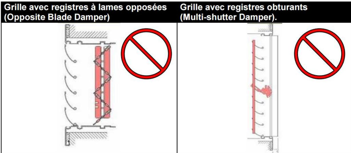
**Figure B-3.4.12.4 et B-3.4.12.5 :** Position des registres d'équilibrage et des trappes d'accès
