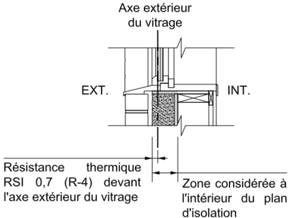
**Figure B-2.3.2.2 :** Continuité de l'isolation pour les systèmes de fenêtrage installés dans un mur en béton
