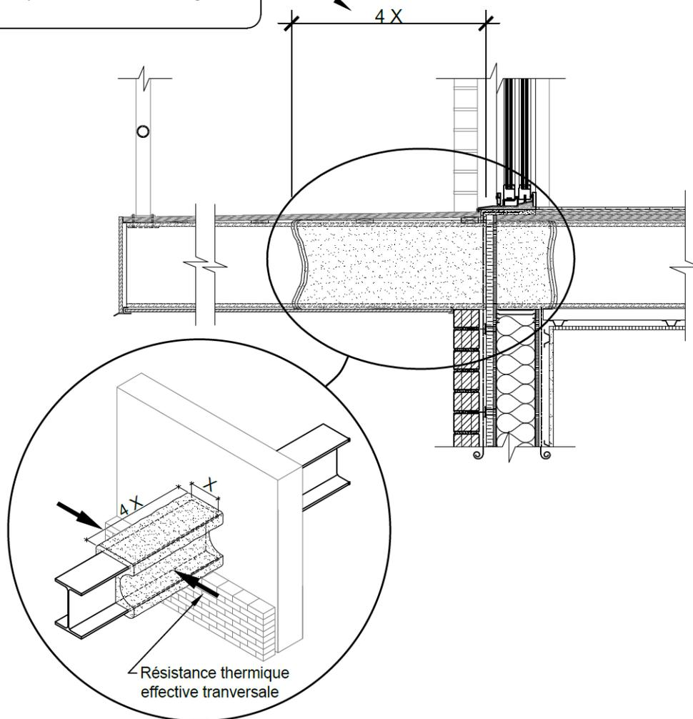
**Figure B-2.1.3.5 a) :** Continuité de l'isolation pour un élément structural en bois – Méthode A)
