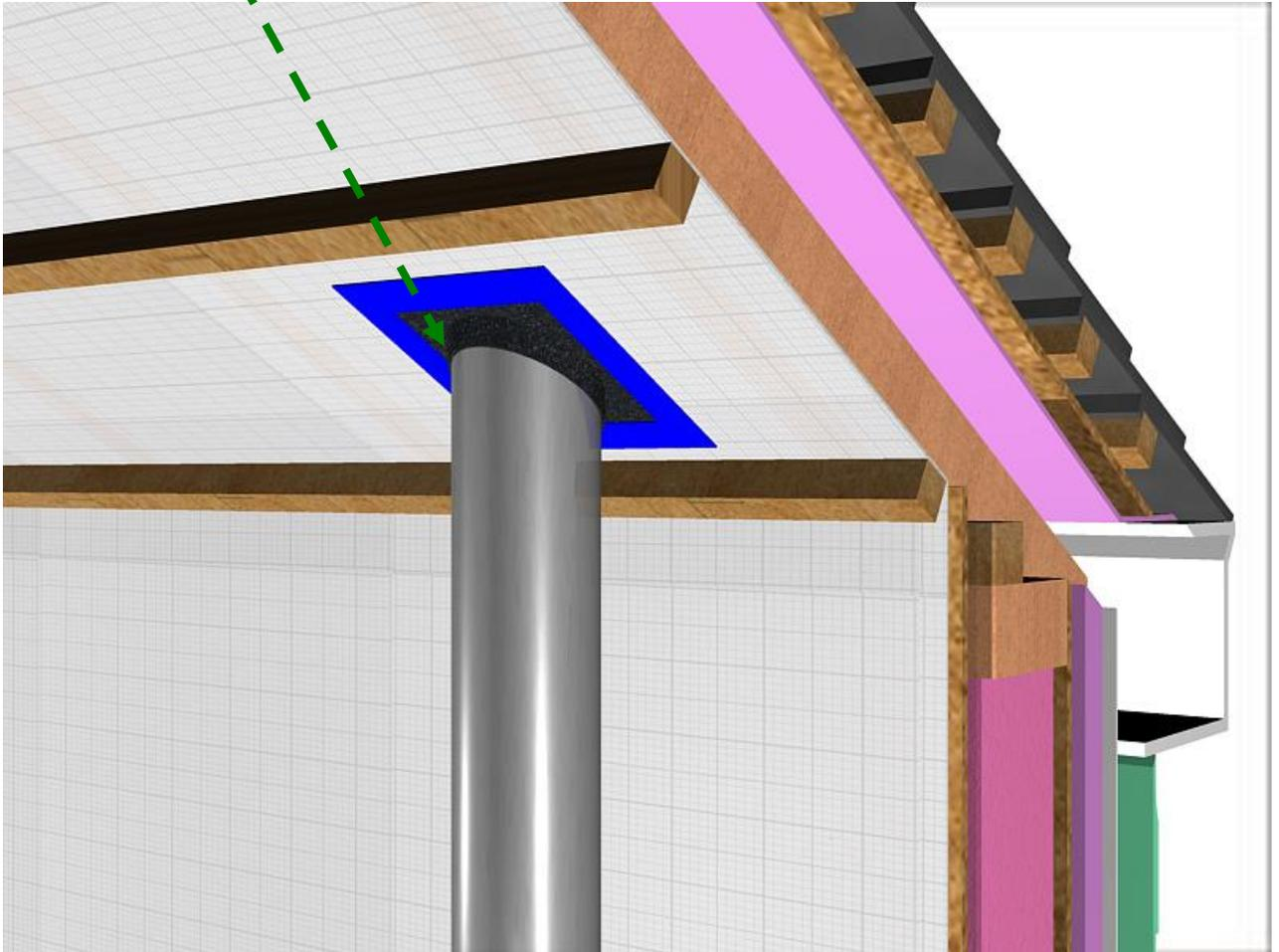
**Figure B-2.2.2.10 (suite) :** Étanchéité spécifique des conduits d'évacuation des produits de combustion
