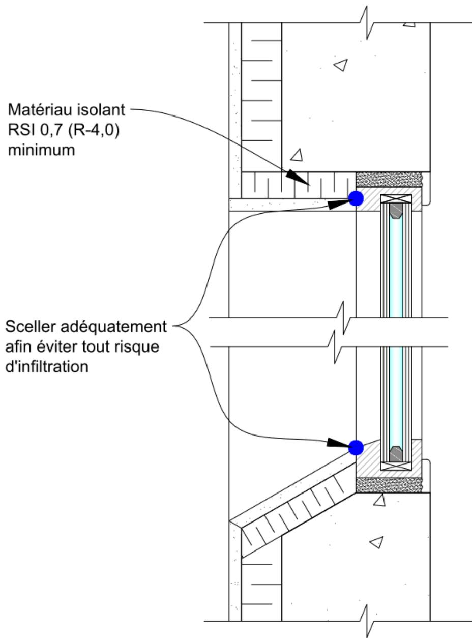
**Figure B-2.3.2.3** : Isolation et étanchéité au pourtour des cadres de fenêtre à l'aide de polyuréthane à faible expansion
