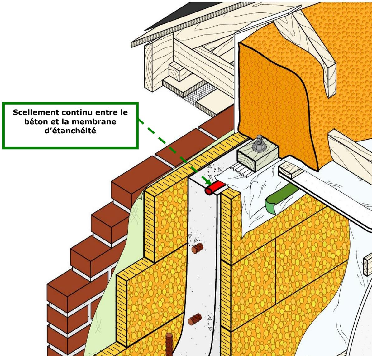
**Figure B-2.2.2.10** : Étanchéité des conduits, tuyaux et canalisation traversant l'enveloppe
