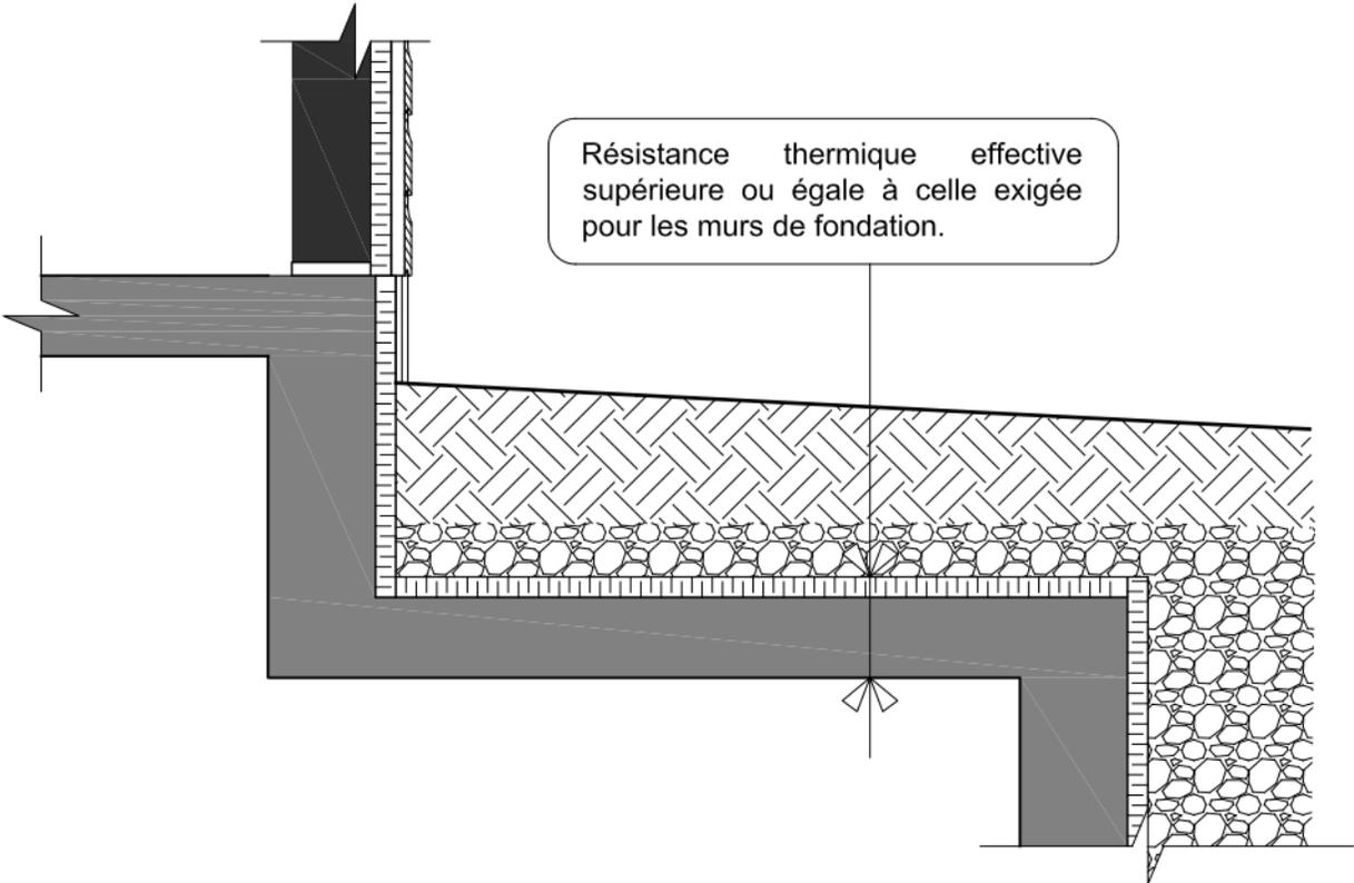
**Figure B-2.1.4.7** : Isolation des parapets, bâtis et séparations de toiture
