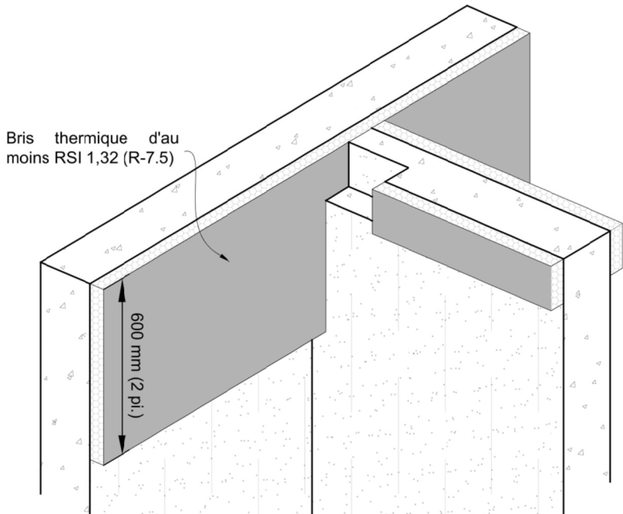
**Figure B-2.1.7.4** : Isolation requise au pourtour et sous une dalle sur sol à semelles intégrées
