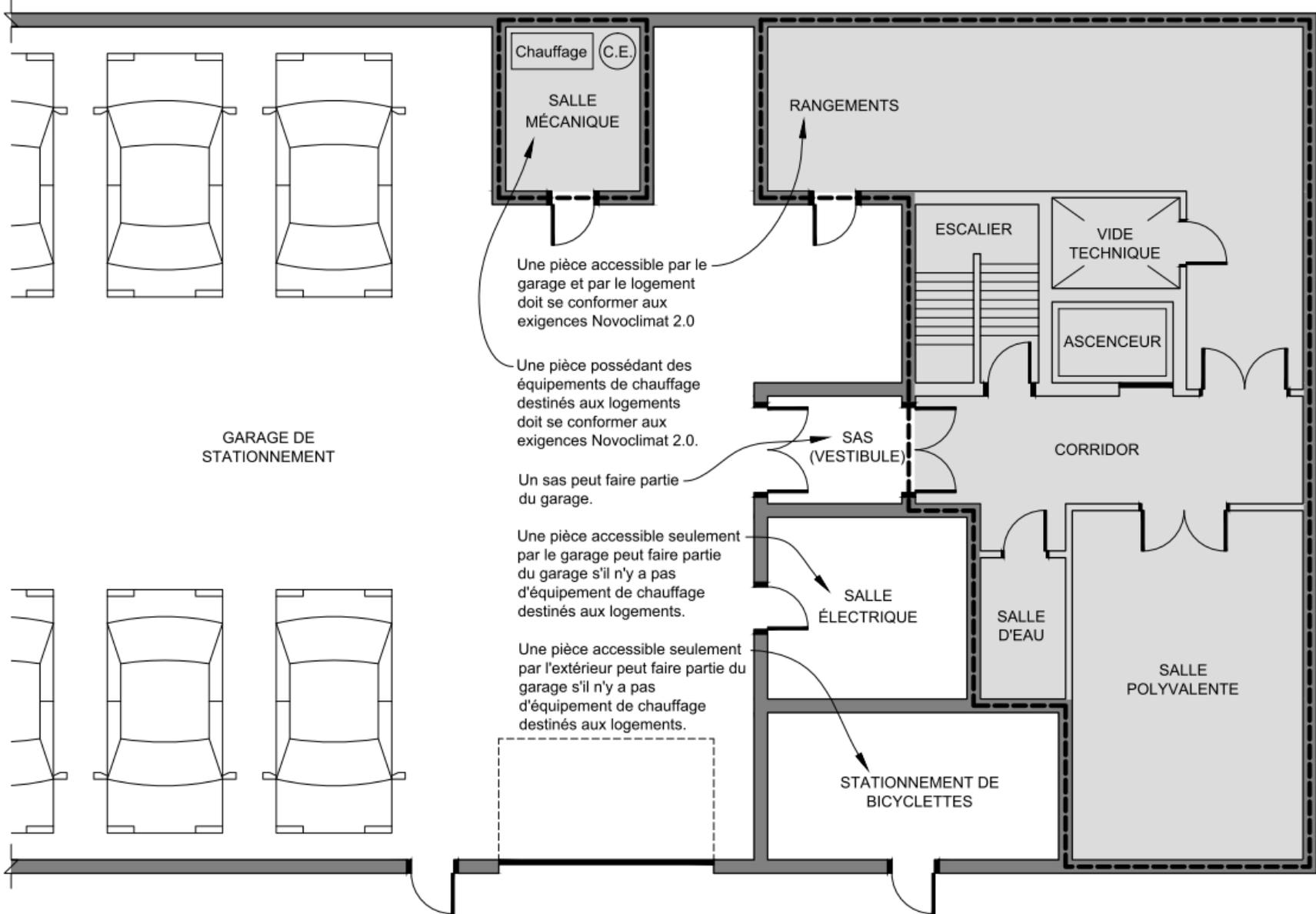
**Figure B-2.4.2.3 :** Parois mitoyennes séparant un garage chauffé d'une pièce chauffée.
