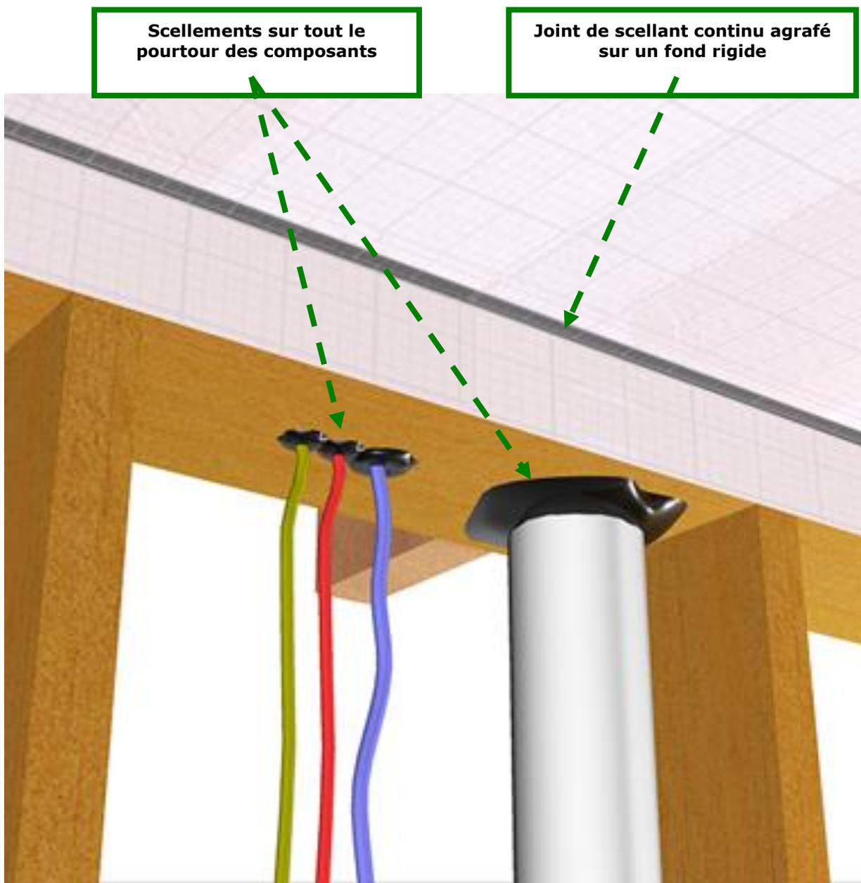
**Figure B-2.2.2.10 (suite) :** Étanchéité des conduits, tuyaux et canalisation traversant l'enveloppe
