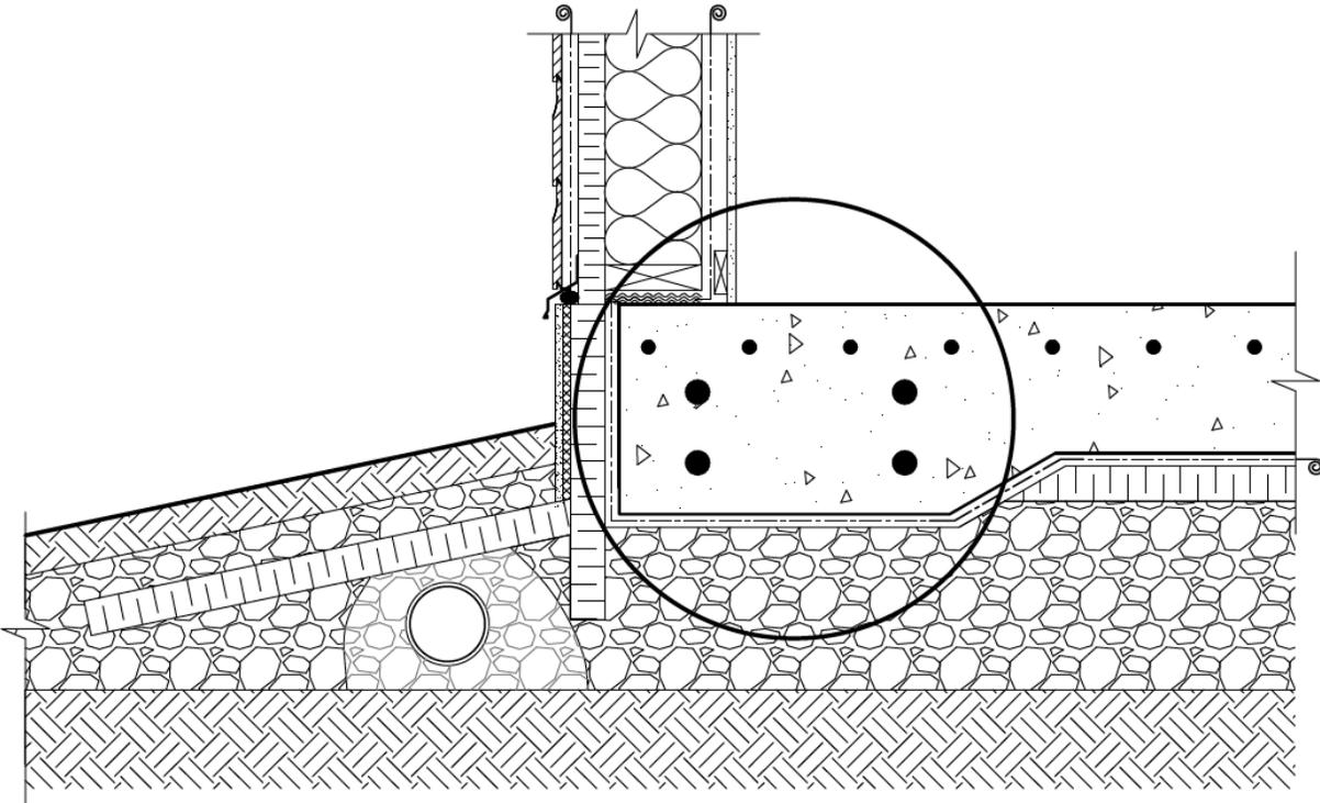
**Figure B-2.1.3.8 b) :** Chevauchement de 2 plans d'isolation distincts pour un mur en blocs de béton
