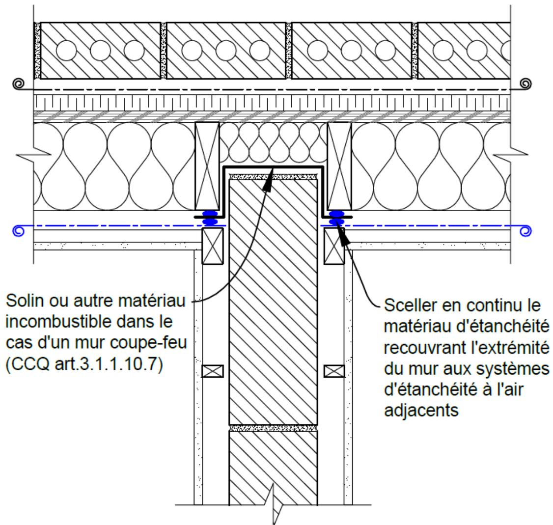
**Figure B-2.2.2.6 a) i), a) ii) et b) i) :** Étanchéité d'un mur mitoyen – Méthode combinée d'obturation et de recouvrement avec scellements adjacents
