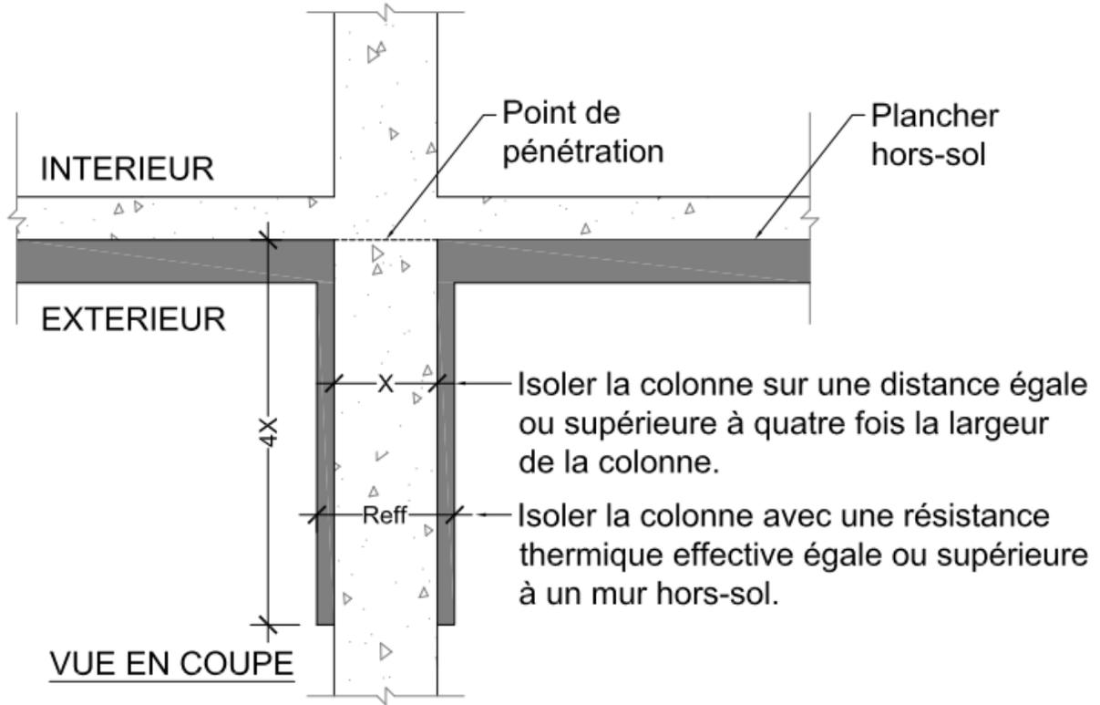
**Figure B-2.1.3.5 b) :** Continuité de l'isolation pour un élément structural - Méthode B)
