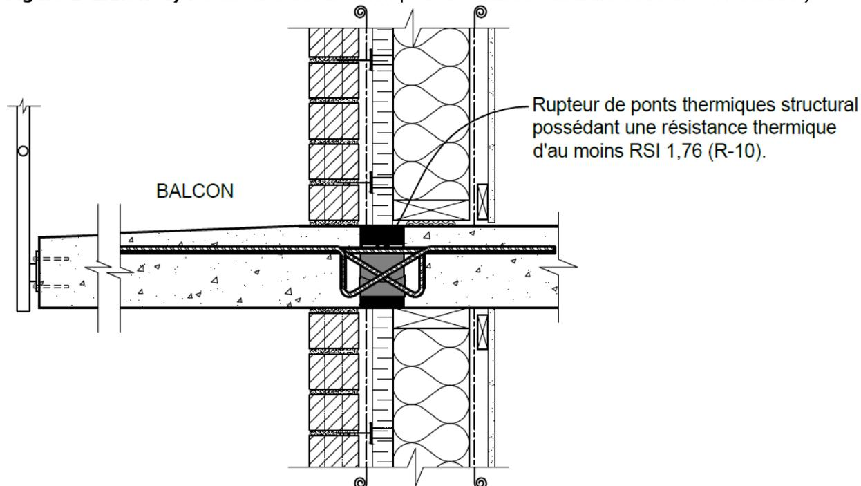
**Figure B-2.1.3.7 a) (suite) :** Continuité de l'isolation pour une dalle structurale en béton – Méthode A)
