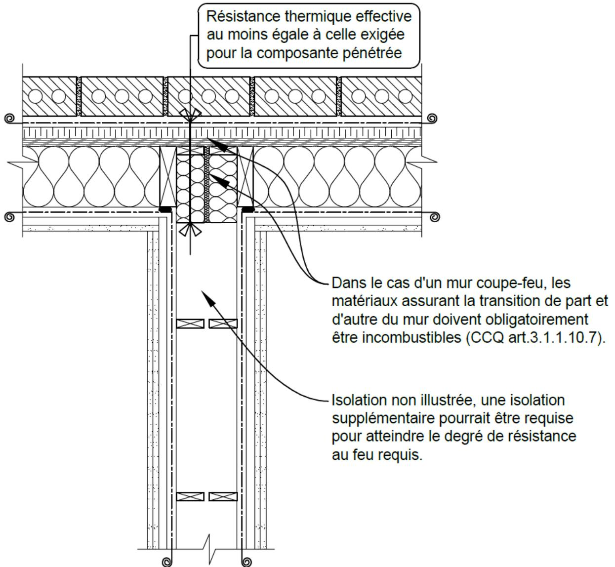
**Figure B-2.1.3.5 a) :** Continuité de l'isolation pour un élément structural - Méthode A)
