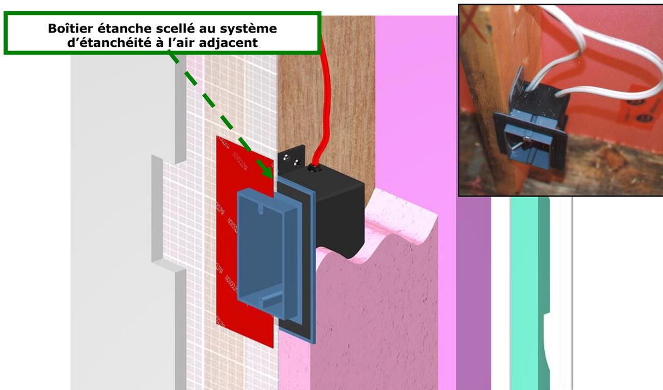
**Les produits de scellement doivent être compatibles avec le système d'étanchéité.**
