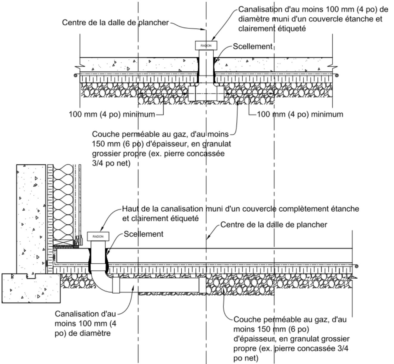
**Figure B-2.2.3.3 :** Scellement des principales voies d'infiltration du radon
