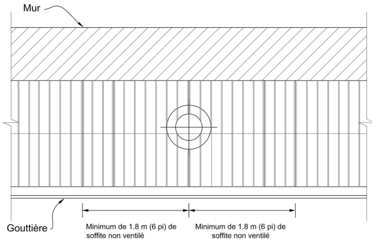
**Figure B-3.4.11.2 :** Distance minimale à respecter pour les bouches extérieures
