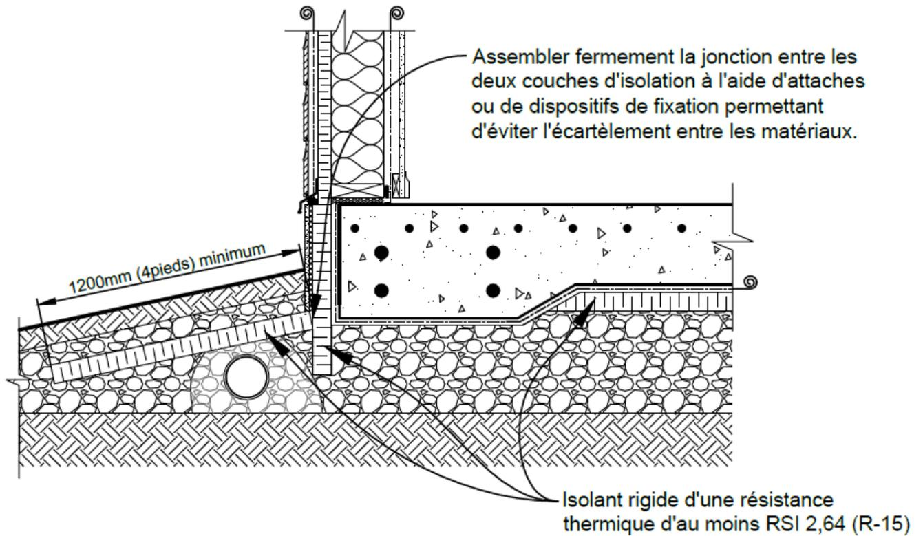
Figure B-2.2.2.2 : Sources fréquentes d'infiltrations et d'exfiltrations d'air
