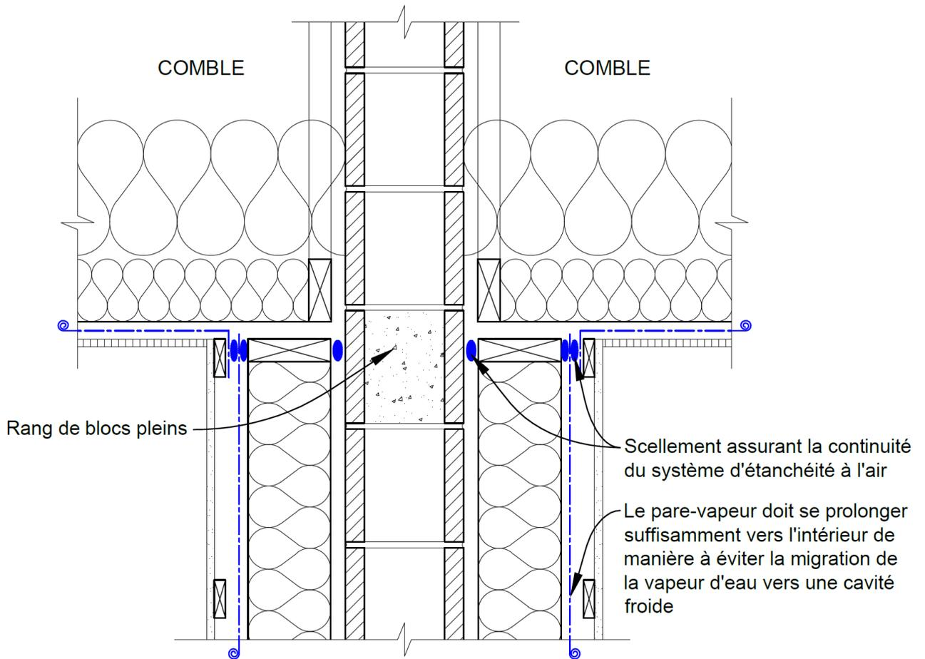
**Figure B-2.2.2.6 a) ii) et b) i) :** Étanchéité d'un mur mitoyen - Recouvrement et scellements adjacents
