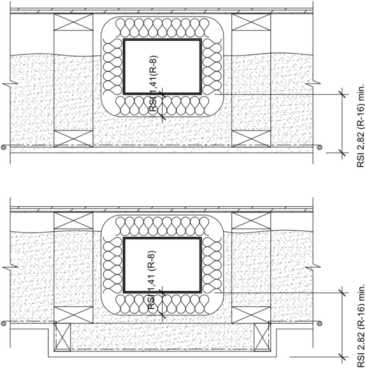
Figure B-3.4.9.2 : Positionnement de la grille d'alimentation (exemples)
