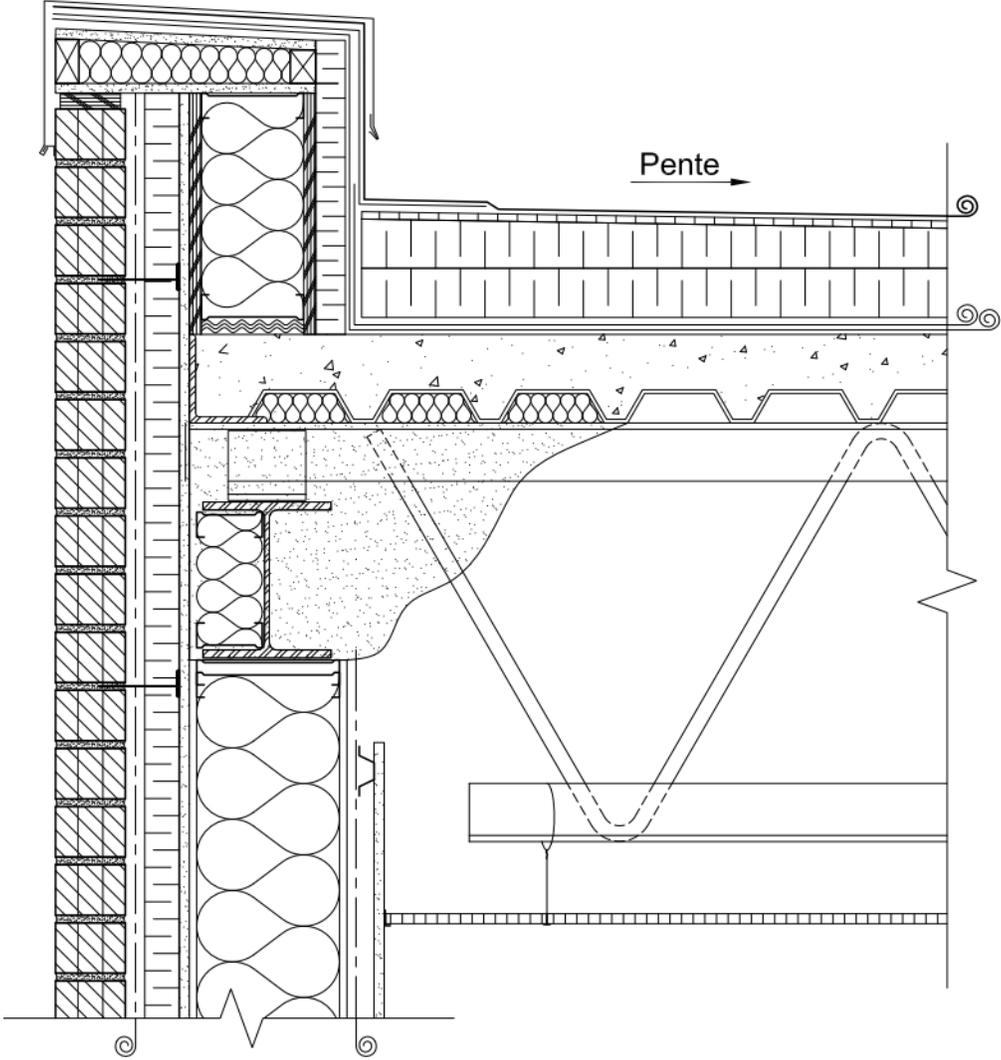
**Figure B-2.1.4.7 (suite) :** Isolation des parapets, bâtis et séparations de toiture
