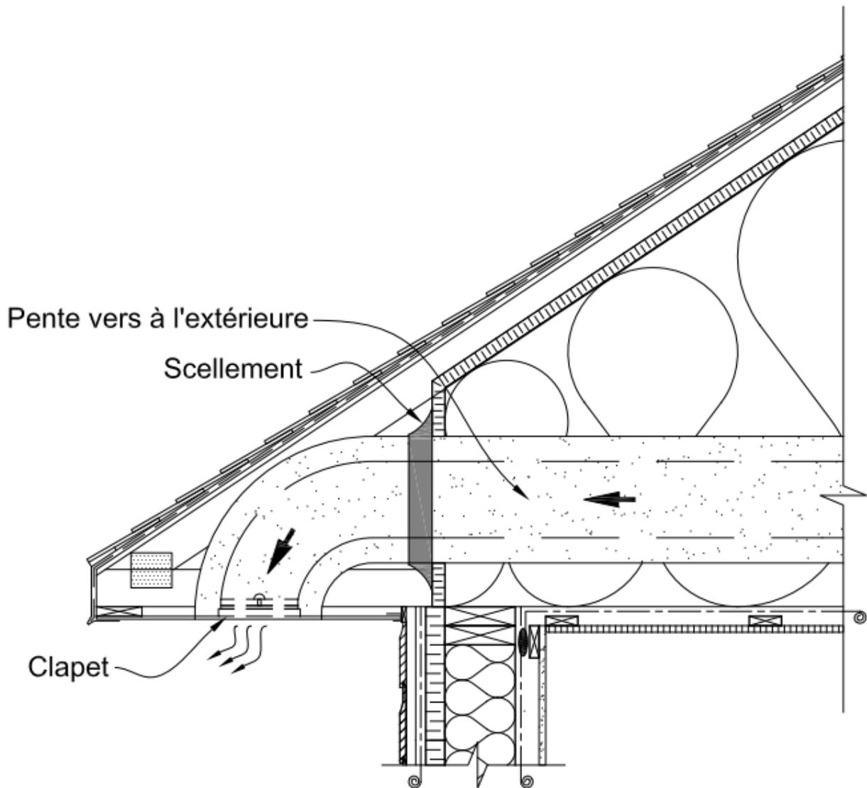
**Figure B-3.4.11.1 :** S'il est impossible d'installer les bouches extérieures pour l'extraction de l'air vicié selon l'article 3.4.8.11 a) et b), alors il est possible de les installer dans les corniches
