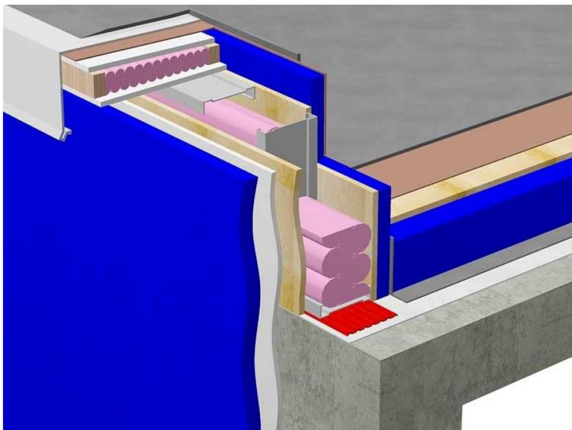
Figure B-2.1.4.7 (suite) : Isolation des parapets, bâtis et séparations de toiture
