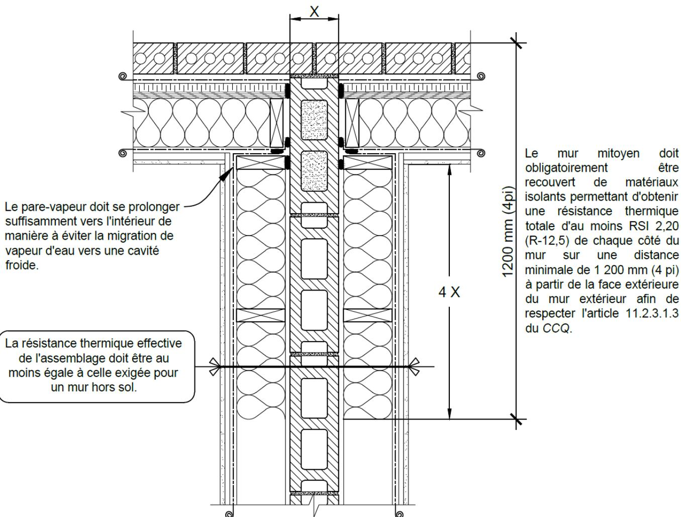
**Figure B-2.1.3.5 b) :** Continuité de l'isolation pour un mur mitoyen – Méthode B)
