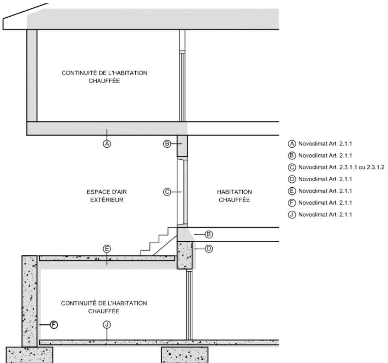
**Figure B-3.1.7.1, 3.2.4.5 & 3.4.17.2** : Emplacement des systèmes de chauffage destinés aux logements (maison à un étage)
