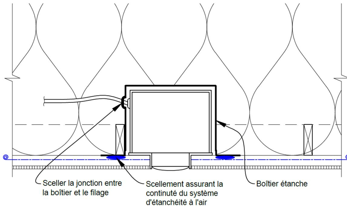
**Figure B-2.2.3.1** : Protection contre l'infiltration d'air et de gaz souterrains pour les planchers en contact avec le sol
