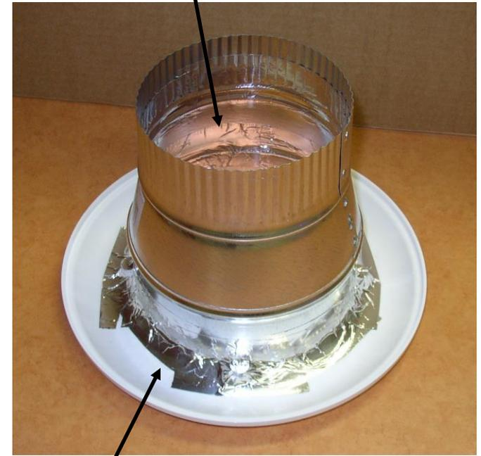
**FABRIQUER DEUX ENTONNOIRS POUR LE MESURAGE DES DÉBITS DES GRILLES DU SOUS-SOL SANS FINITION AU PLAFOND (voir feuille suivante)**
