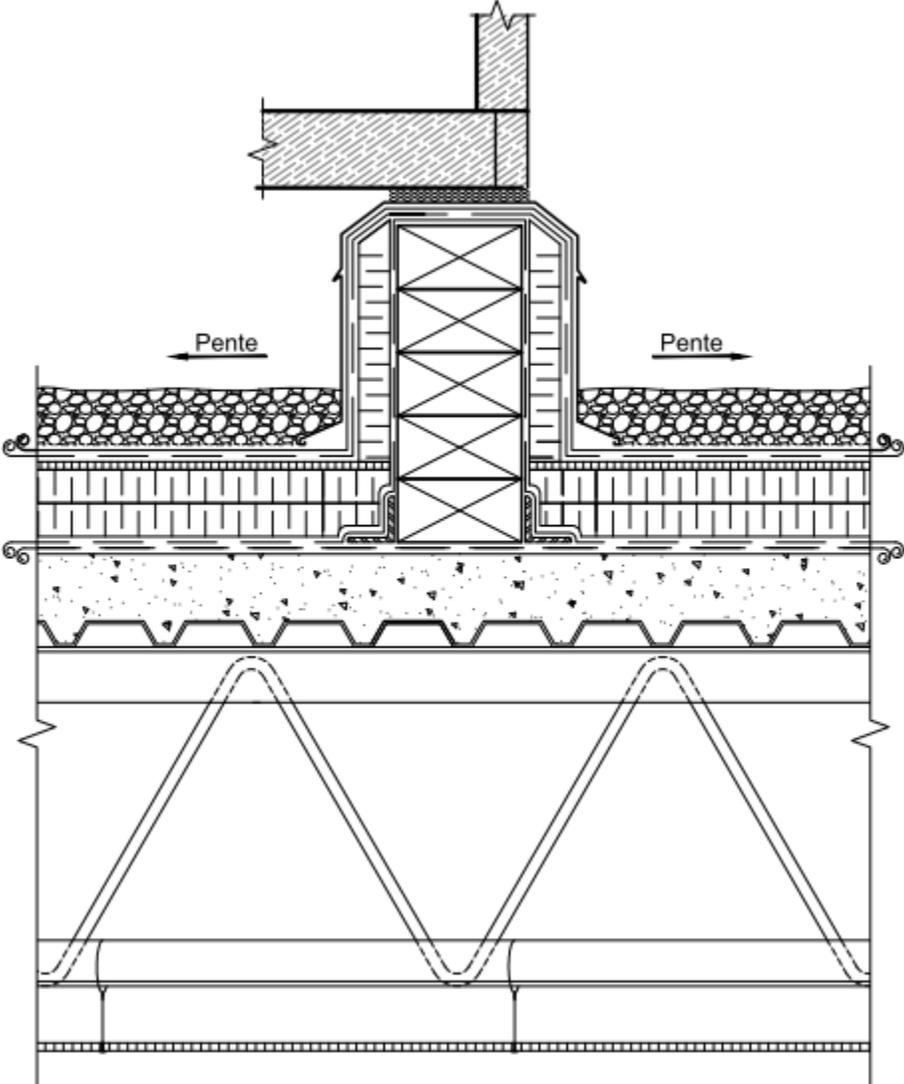
**Figure B-2.1.7.3 b) :** Prolongement par l'intérieur du bris thermique pour une dalle sur sol
