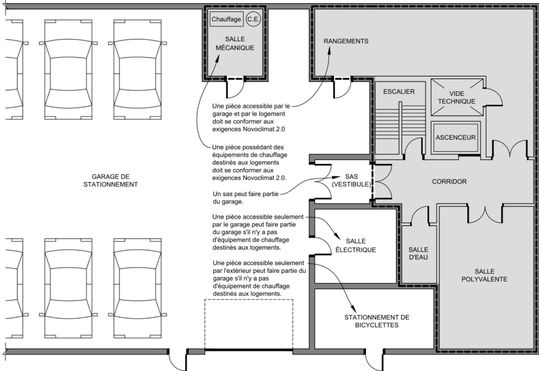
**Figure B-2.4.2.3** : Parois mitoyennes séparant un garage des autres espaces chauffés
