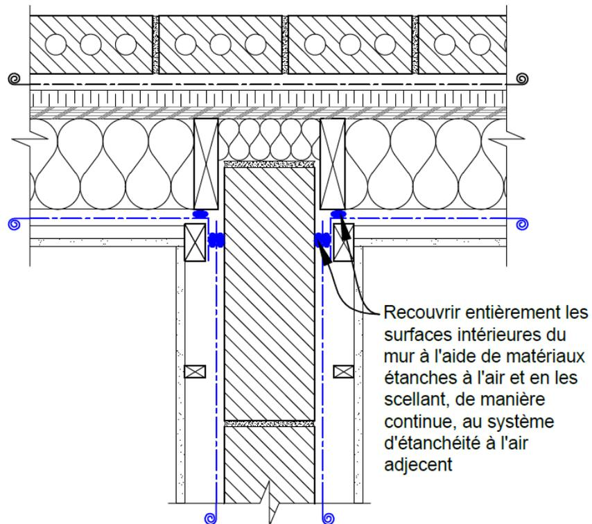
**Figure B-2.2.2.8** : Étanchéité à l'air dans le cas des murs construits en coffrage isolant
