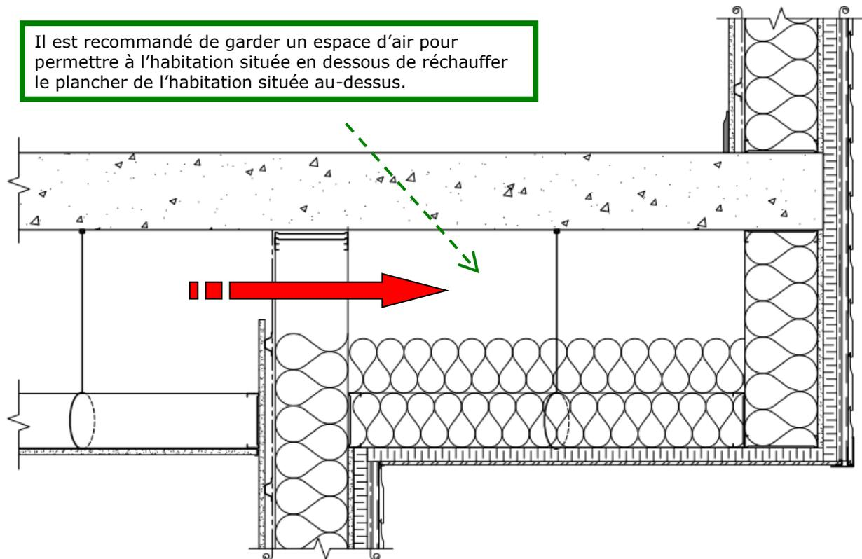
**Figure B-2.1.1 note 8) (suite) :** Isolation d'un plancher séparant un espace chauffé d'un espace non chauffé (art.2.1.1)
