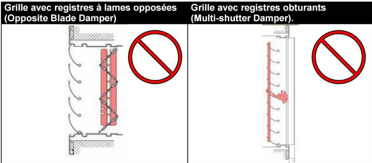
**Figure B-3.4.12.4 et B-3.4.12.5 :** Position des registres d'équilibrage et des trappes d'accès
