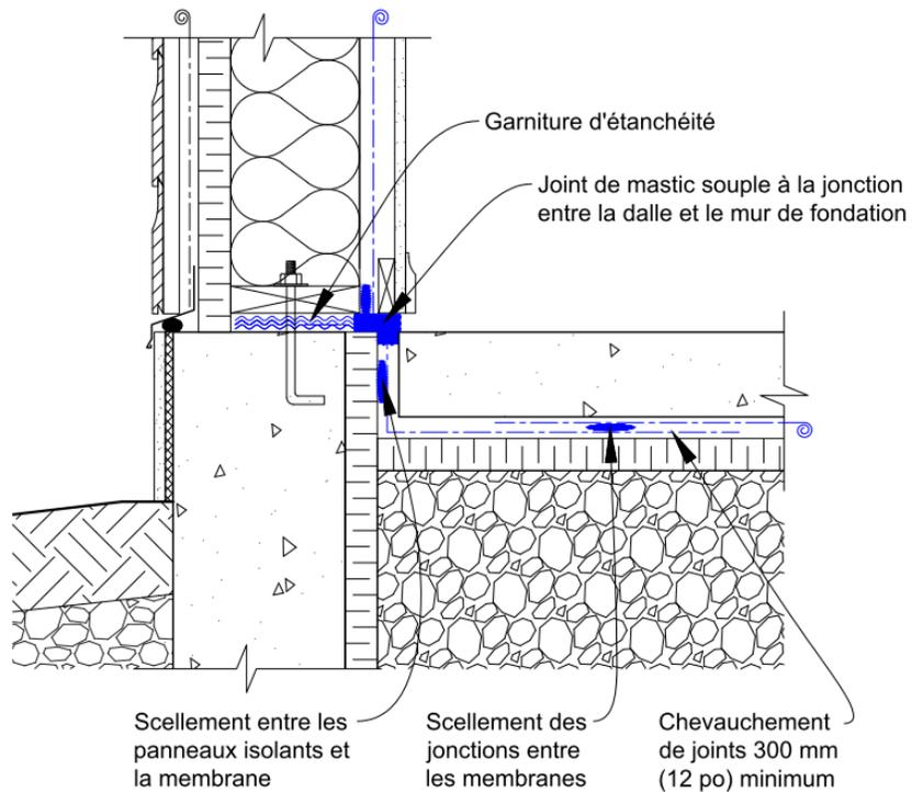
**Figure B-2.2.3.2 a) :** Dispositif permettant le raccordement d'un système d'évacuation du radon
