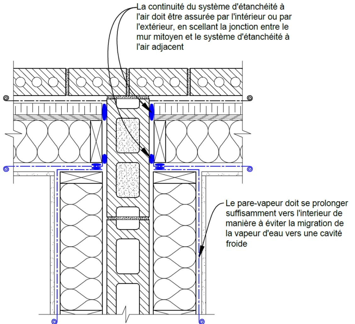
**Figure B-2.2.2.6 a) i) et b) i) (suite) : Étanchéité d'un mur mitoyen – Obturation et scellements adjacents**
