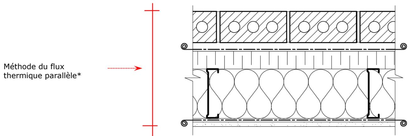
**$RSI_2$**  = résistance thermique effective de l'assemblage complet déterminée à l'aide de la méthode des plans isothermes et de la méthode du flux thermique parallèle combiné (même méthode utilisée pour calculer la résistance thermique effective des assemblages en ossature de bois\*);
