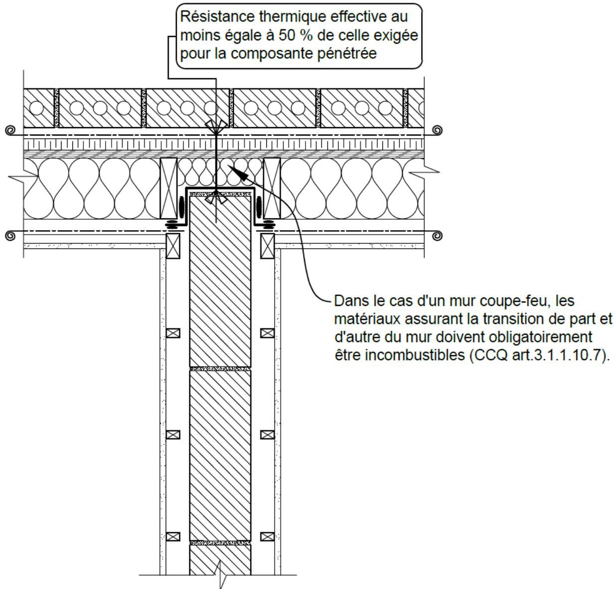
**Figure B-2.1.3.5 b) (suite) :** Continuité de l'isolation pour un mur mitoyen – Méthode B).
