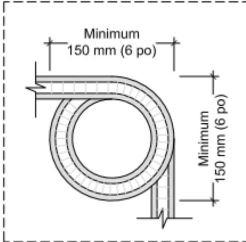
Une trappe à chaleur peut aussi être fait à l'aide d'un tuyau flexible isolé.
