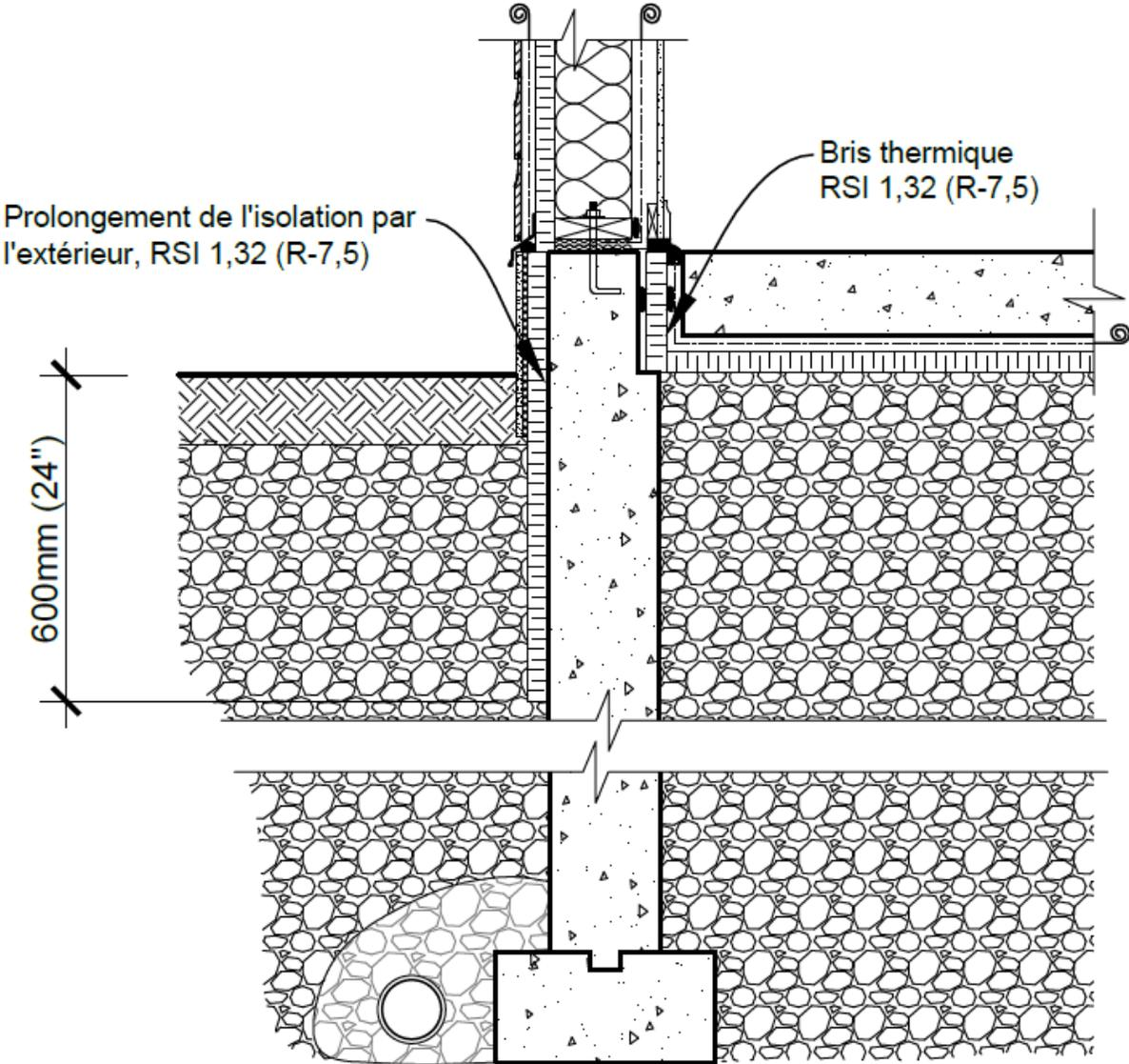
**Figure B-2.1.7.3 c) :** Bris thermique en continuité au pourtour de la dalle
