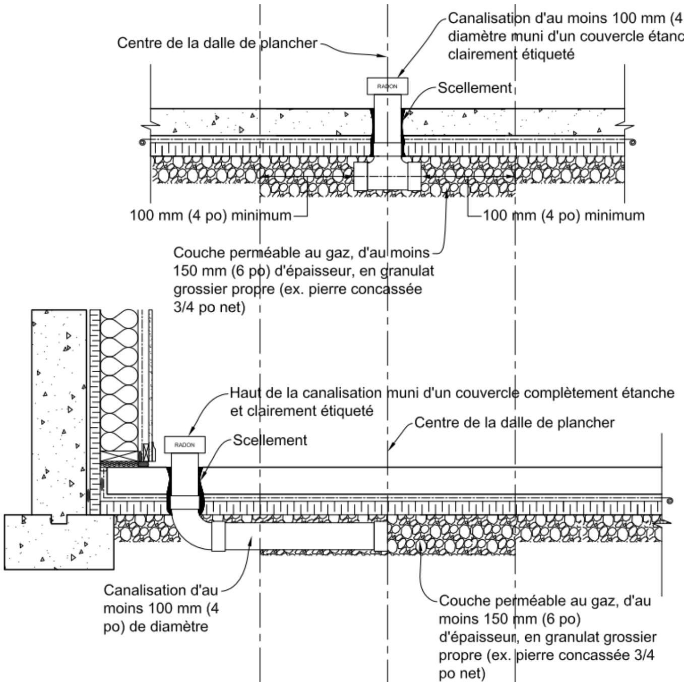
**Figure B-2.2.3.3 :** Scellement des principales voies d'infiltration du radon
