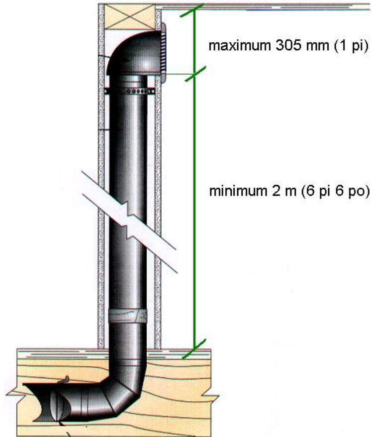
**Figure B-3.4.10.3 d) :** Positionnement de la grille d'extraction dans une salle de bain
