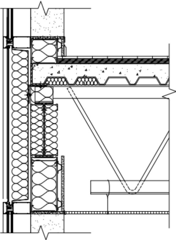
**Figure B-2.3.1.7 b) :** Isolation des trappes d'accès à la toiture (écoutille de toiture)
