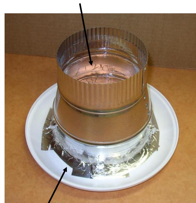
**FABRIQUER DEUX ENTONNOIRS POUR LE MESURAGE DES DÉBITS DES GRILLES DU SOUS-SOL SANS FINITION AU PLAFOND (voir feuille suivante)**
