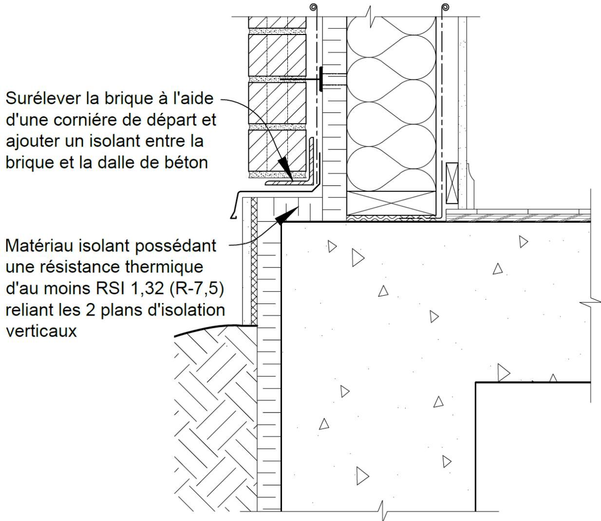
**Note** : Il est important de prendre les précautions nécessaires afin de préserver la stabilité structurale de l'assemblage.
