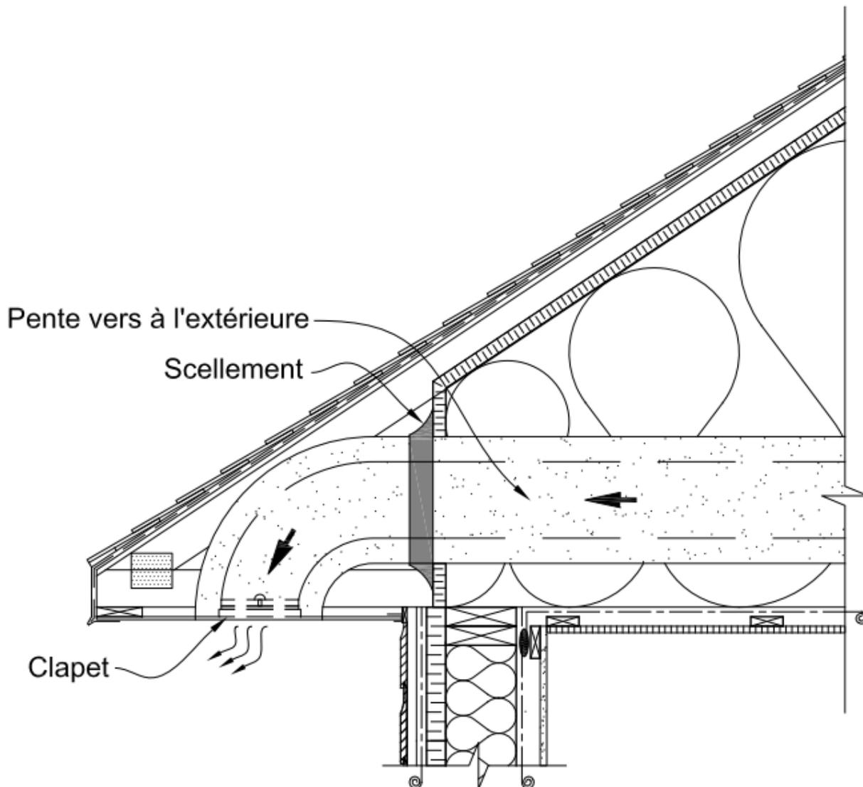
**Figure B-3.4.11.1** : Lorsqu'elles sont préalablement approuvées par le *Service technique Novoclimat* : installation des bouches de sorties d'air vicié par les corniches
