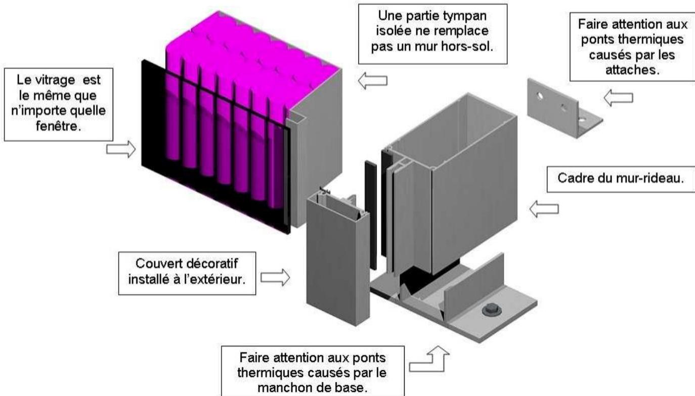
**Figure B-2.3.1.2 b) (suite)** : Vue en coupe d'une section isolée d'un mur-rideau
