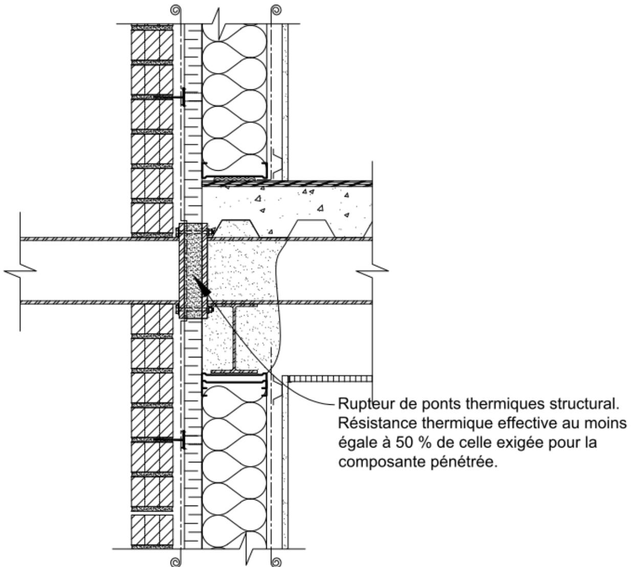
**Note :** Il est important de prendre les précautions nécessaires afin de préserver la stabilité structurale de l'assemblage.
