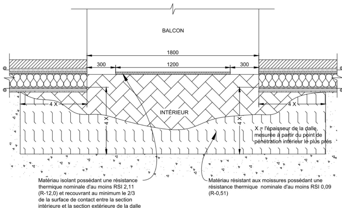
**Note :** La section de dalle en continuité entre l'intérieur et l'extérieur (1/3 restant) doit permettre d'assurer la stabilité structurale de l'assemblage.
