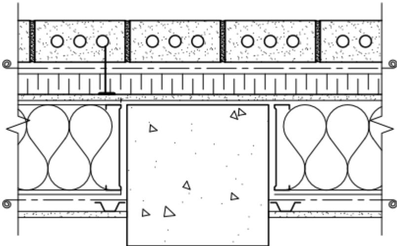
**Figure B-2.1.3.5 c) :** Continuité de l'isolation pour un mur mitoyen – Méthode C )
