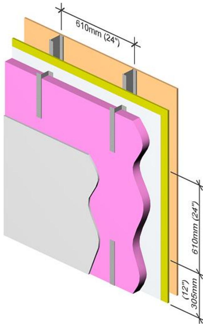
**Note :** Il est important de prendre les précautions nécessaires afin de préserver la stabilité structurale de l'assemblage.
