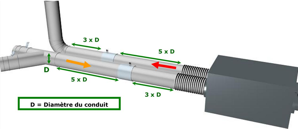
**Figure B-3.4.13.3** : Dessins d'atelier – équipement de balancement
