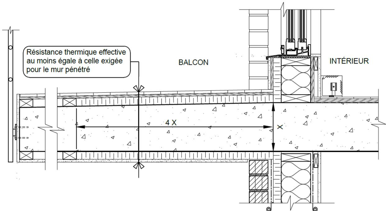
**Figure B-2.1.3.7 c) (suite) :** Continuité de l'isolation pour une dalle structurale en béton – Méthode C)
