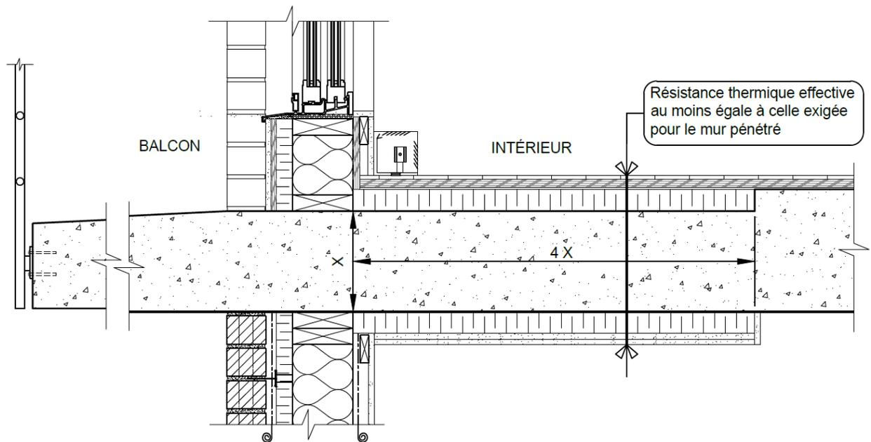
**Figure B-2.1.3.7 d) :** Continuité de l'isolation pour une dalle structurale en béton – Méthode D)
