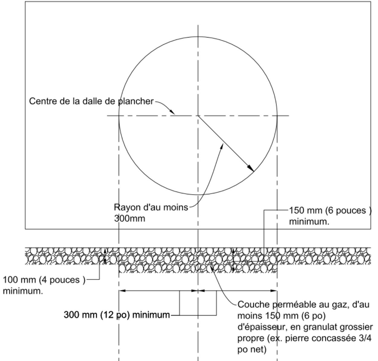
**Figure B-2.2.3.2 b) :** Dispositif permettant le raccordement d'un système d'évacuation du radon
