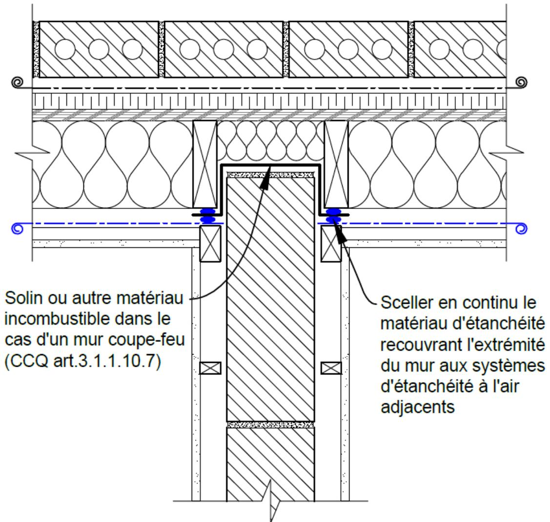
**Figure B-2.2.2.6 a) i), a) ii) et b) i) :** Étanchéité d'un mur mitoyen – Méthode combinée d'obturation et de recouvrement avec scelllements adjacents
