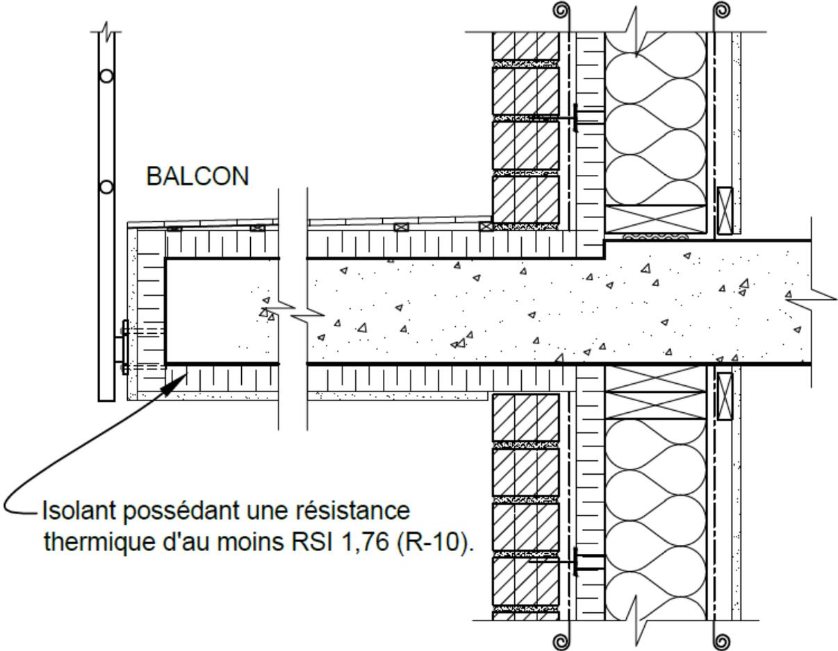
**Figure B-2.1.3.7 c) :** Continuité de l'isolation pour une dalle structurale en béton – Méthode C)
