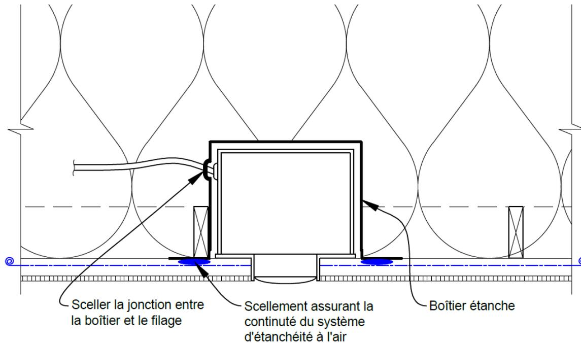
**Figure B-2.2.3.1** : Protection contre l'infiltration d'air et de gaz souterrains pour les planchers en contact avec le sol
