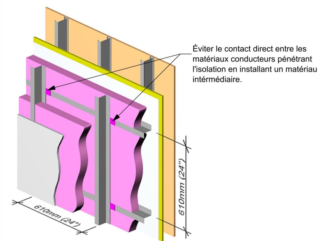
**Note :** Il est important de prendre les précautions nécessaires afin de préserver la stabilité structurale de l'assemblage.
