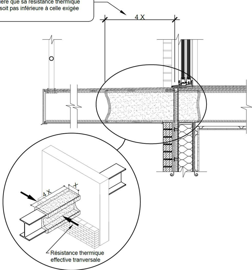
**Figure B-2.1.3.5 b) :** Continuité de l'isolation pour un élément structural - Méthode B)
