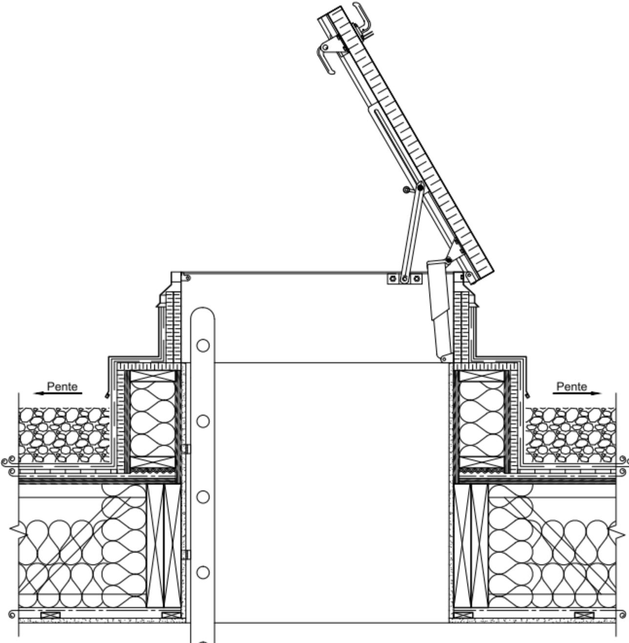
**Figure B-2.3.2.1** : Alignement maximal du vitrage
