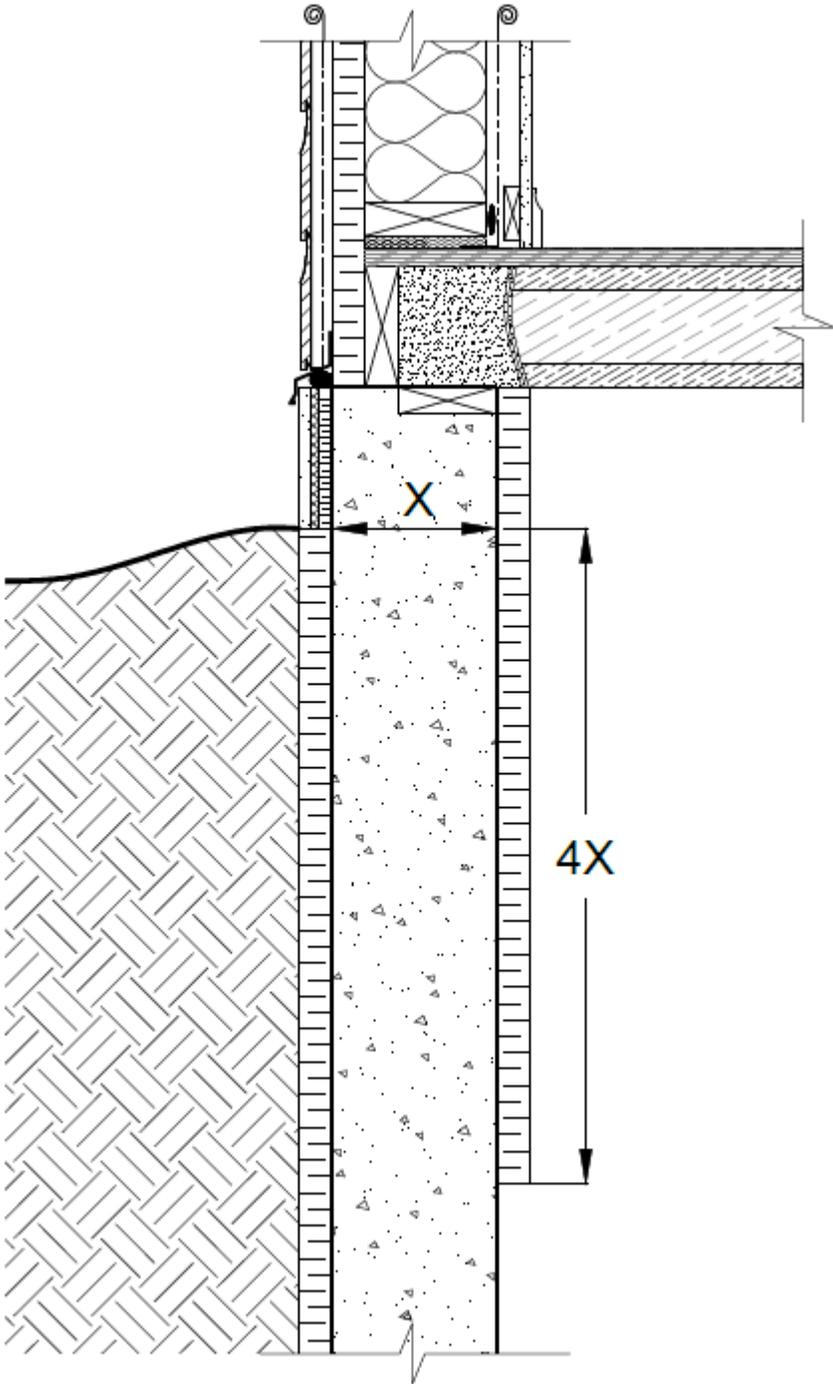
**Figure B-2.1.3.8 a) i) :** Exemption pour le chevauchement des plans d'isolation
