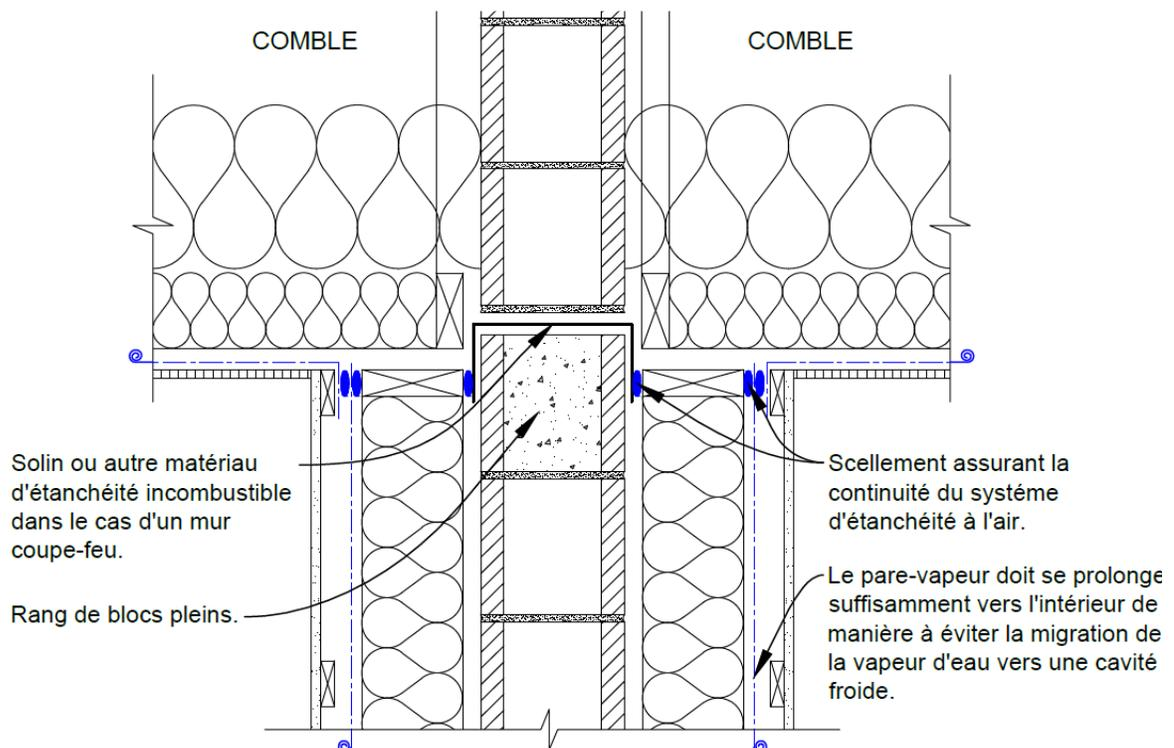
**Figure B-2.2.2.6 b) ii) :** Étanchéité d'un mur mitoyen – Recouvrement complet de toutes les surfaces intérieures
