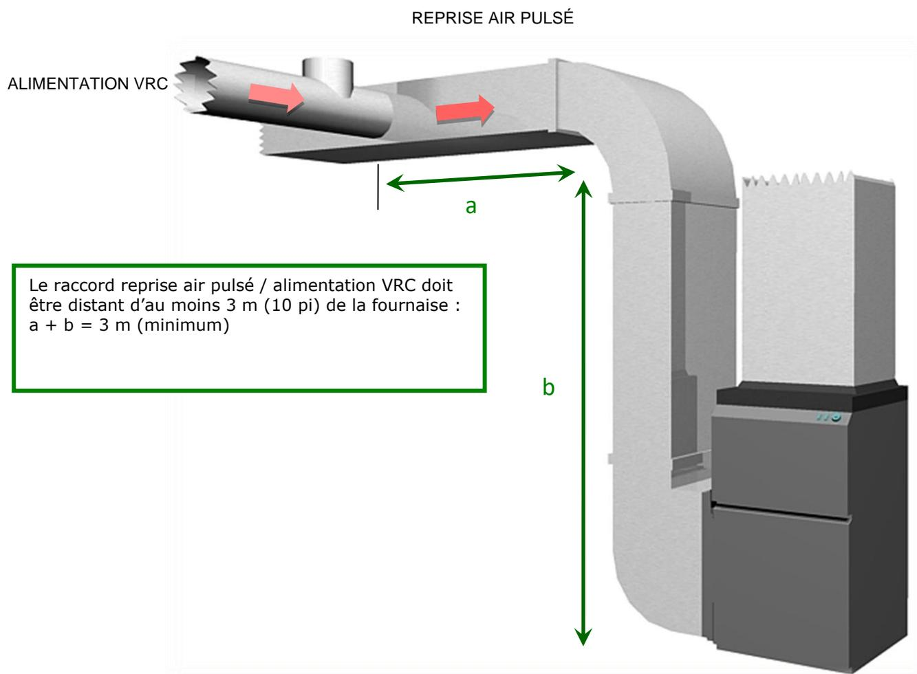
**Figure B-3.4.17.9 :** Raccordement entre le conduit de reprise du générateur d'air et le conduit d'alimentation côté chaud du VRC
