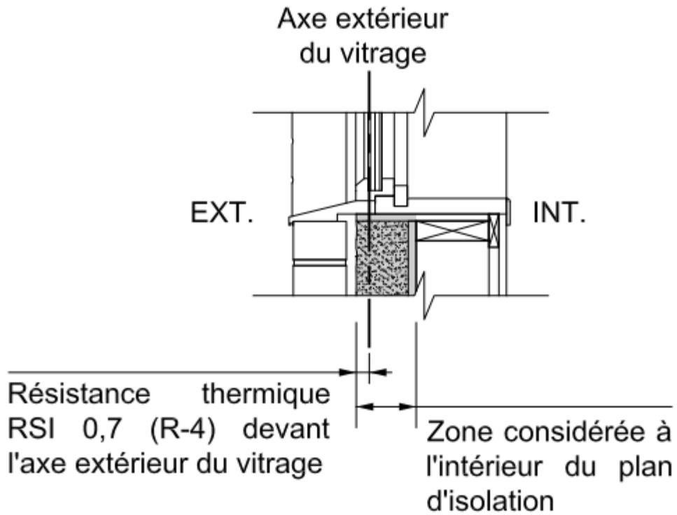
**Figure B-2.3.2.3** : Isolation et étanchéité au pourtour des cadres de fenêtre à l'aide de polyuréthane à faible expansion
