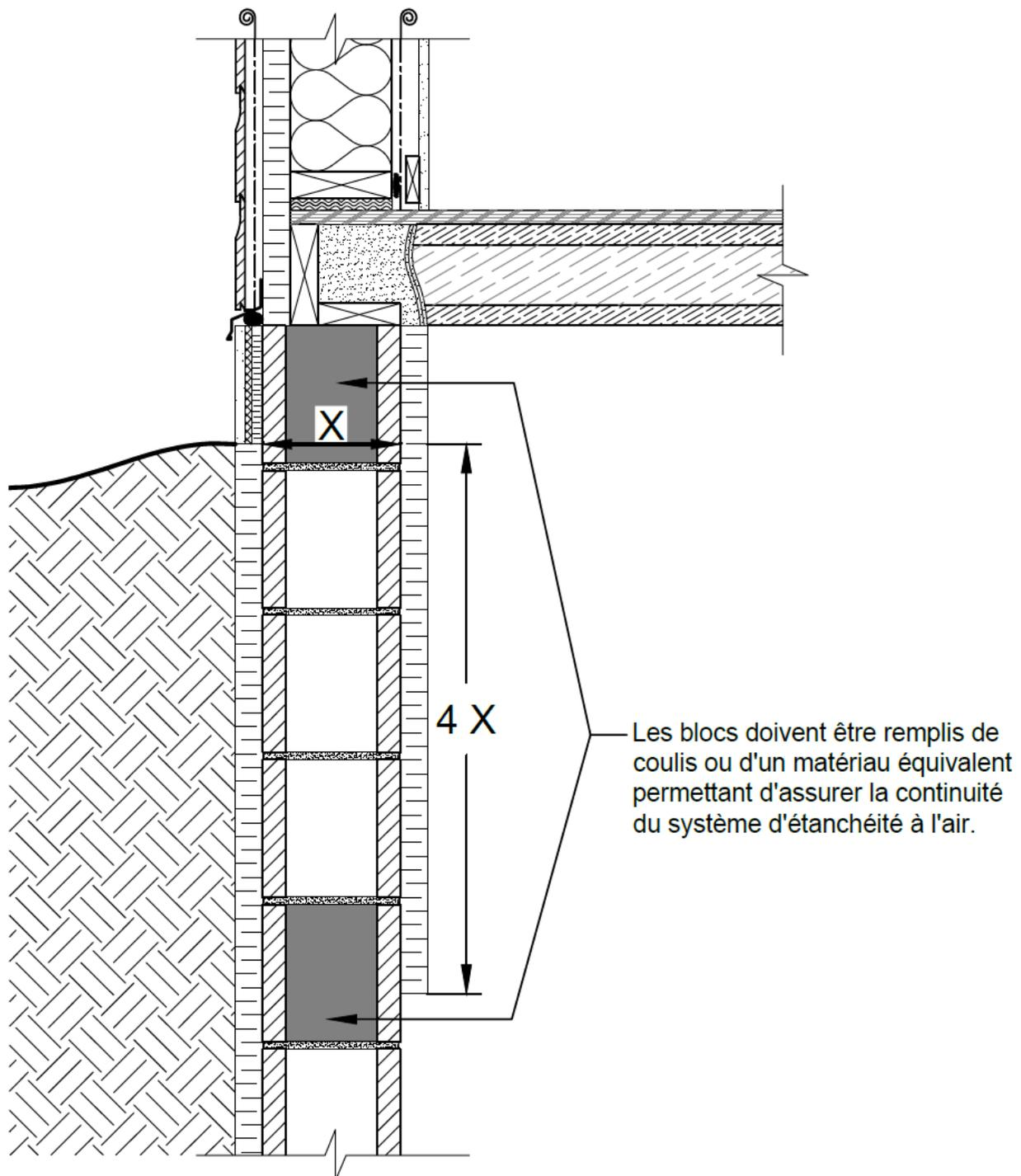
**Figure B-2.1.3.8** : Recouvrement du pont thermique à la jonction entre un mur de fondation isolé par l'extérieur et un mur hors sol avec parement extérieur en maçonnerie
