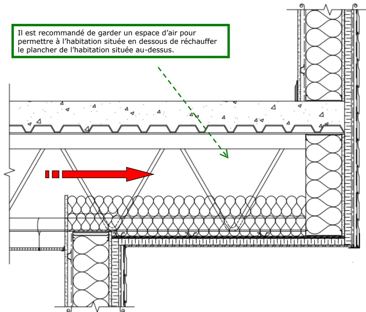
**Figure B-2.1.3.4 a)** : Réduction des ponts thermiques pour les dispositifs d'ancrage, de support ou de fixation
