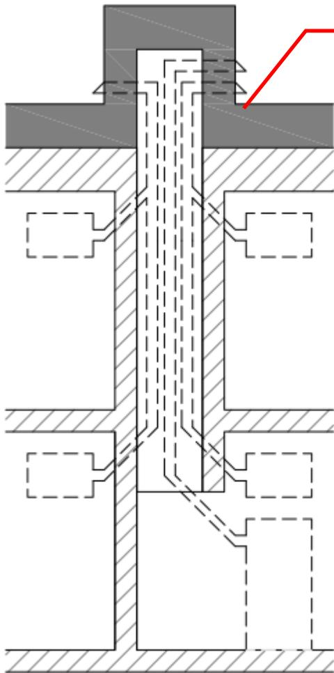
Les sections verticales doivent être isolées comme des murs hors sol et les sections horizontales comme des toitures (voir tableau 2.1.1)
