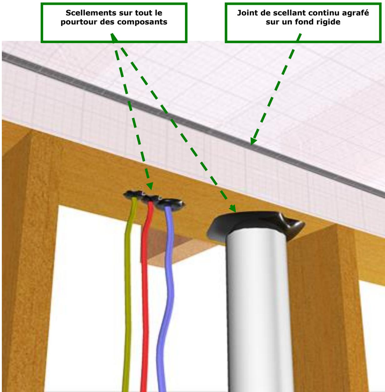
**Figure B-2.2.2.10 (suite) :** Étanchéité des conduits, tuyaux et canalisation traversant l'enveloppe
