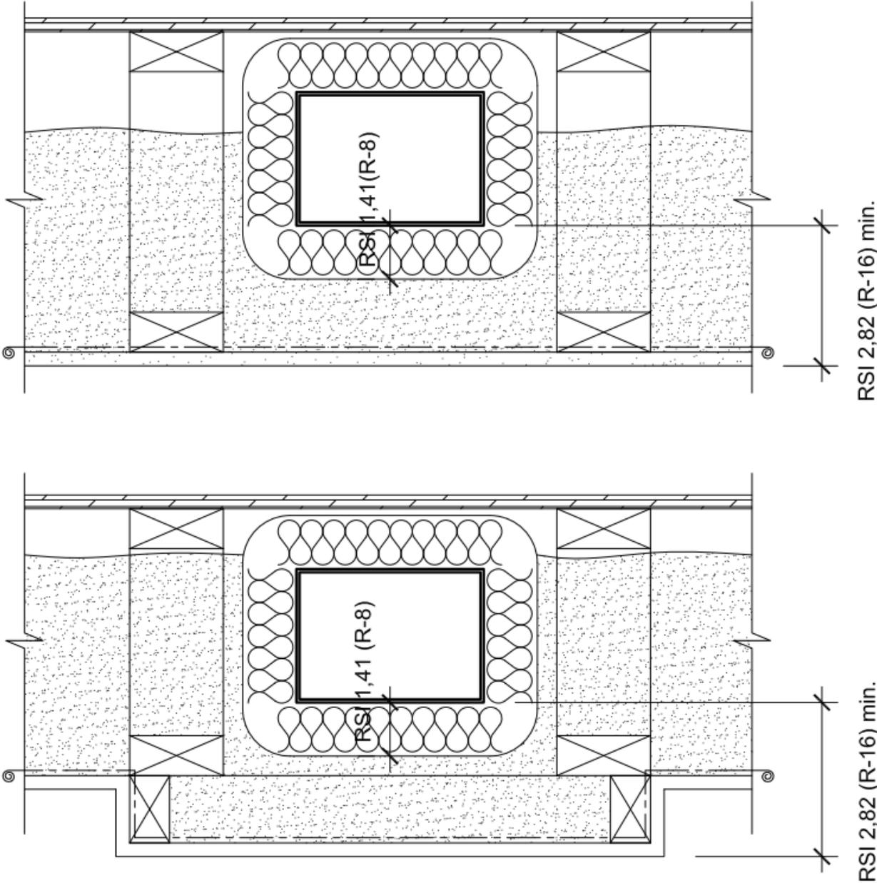
**Figure B-3.4.11.3 et B-3.4.8.10 c) :** Scellement hermétique au pourtour des conduits qui traversent le système d'étanchéité à l'air
