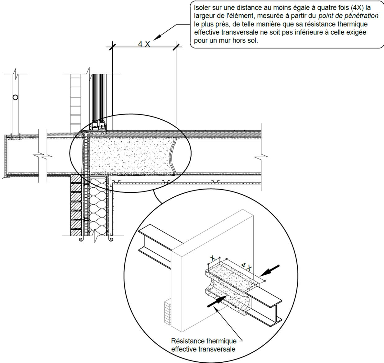
**Figure B-2.1.3.5 a) (suite) :** Continuité de l'isolation pour un élément structural - Méthode A)
