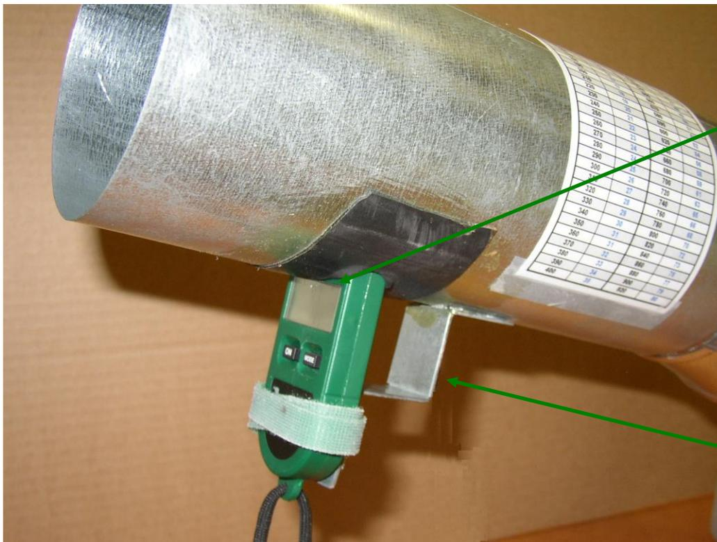
La position de l'anémomètre doit toujours être la même. Lors des mesurages des débits d'air, insérer l'anémomètre à hélice jusqu'à la limite supérieure de l'écran.
