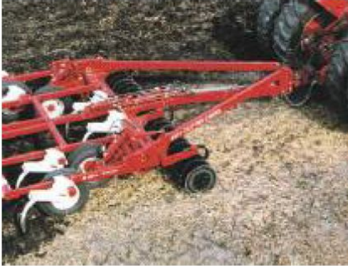
Figure 4-21 Équipement combiné, herse à disques et chisel, pour le travail réduit du sol (CPVQ, 2000)
